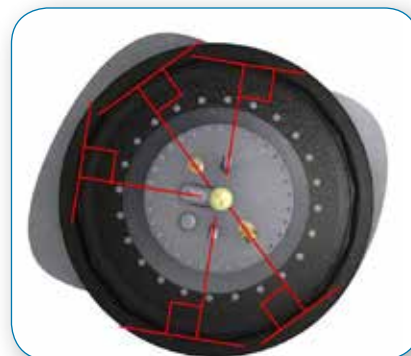
Assegurar que os tubos estão em ângulo reto em relação à parede da câmara e encaixes na tampa de inspeção.
