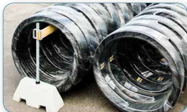
Rolos armazenados na vertical, devem ser apoiados para evitar deformação do tubo.
