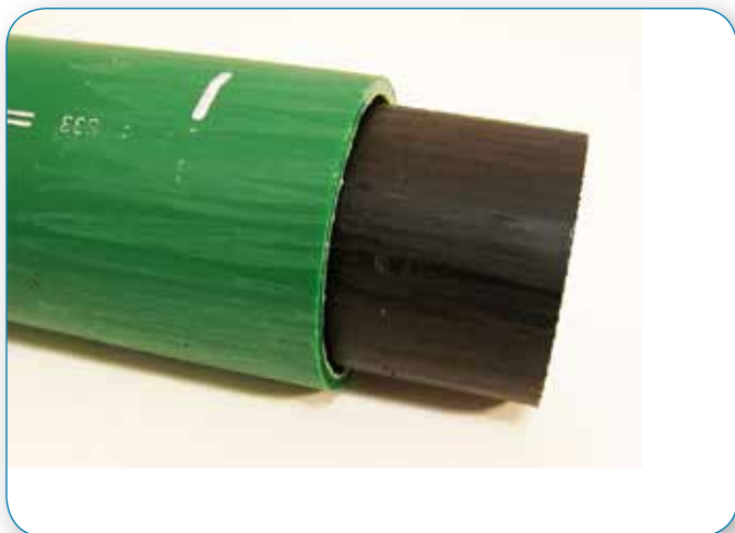
Raspagem insuficiente. Nem todas as zonas foram raspadas.
