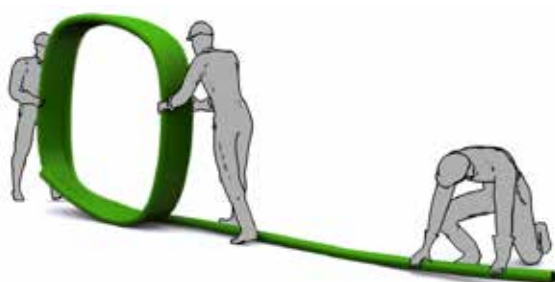
Uma forma boa e segura de desenrolar o tubo é com 3 pessoas.
