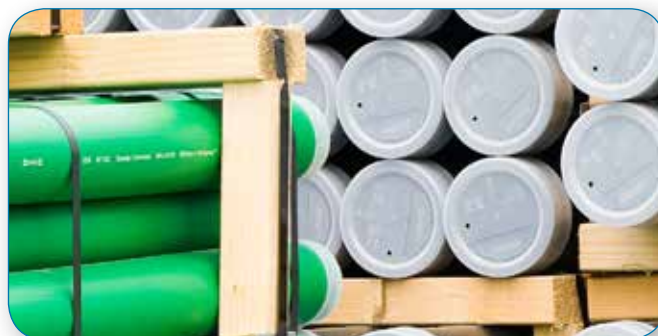
As tampas da extremidade devem ser mantidas nos tubos até à instalação para proteger de contaminação e sujidades.
