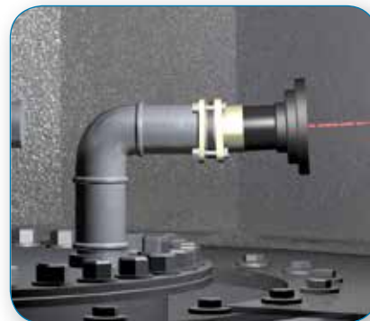
Colocar o ponteiro laser nos encaixes pré-montados na tampa de inspeção.
