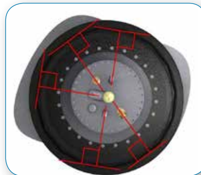
Se till att rören befinner sig i rät vinkel i förhållande till sumpväggen och anslutningarna på manluckan.
